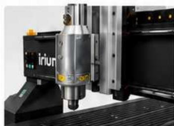
MOTOR SPINDLE 6 kW REFRIGERADO POR AIRE
